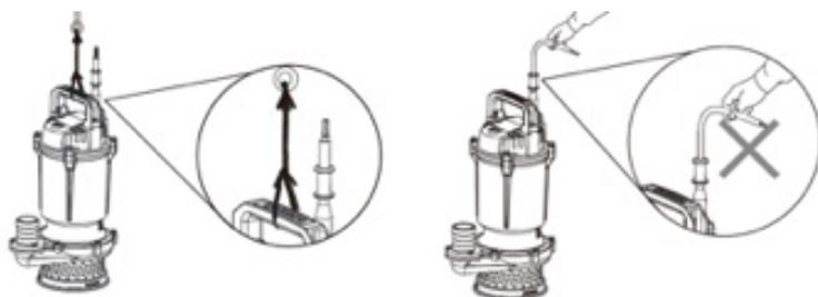
6. Quando a bomba estiver imersa, sua profundidade não deve exceder 5m e deve-se manter uma distância mínima de 0,5m do fundo do poço. O equipamento não deve ser imerso em lama e deve-se prevenir que o impulsor não seja bloqueado ou emperrado. O nível de água deve ser verificado frequentemente para que a bomba nunca trabalhe a seco ou fora da superfície. Instale a bomba na vertical. Mantenha-a no nível da água.
