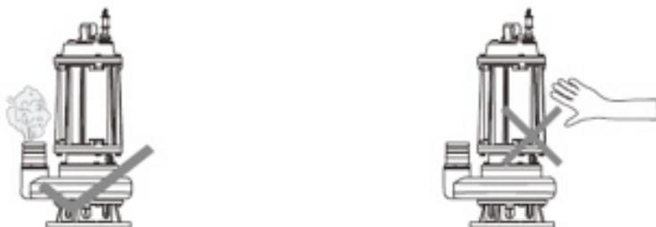
4. A conexão de recalque do equipamento deve ser fixada com uma junta de cano. Pode ser usada uma braçadeira de ferro, uma junta parafusada e deve ser içada pela alça ou anel de içamento do equipamento.
