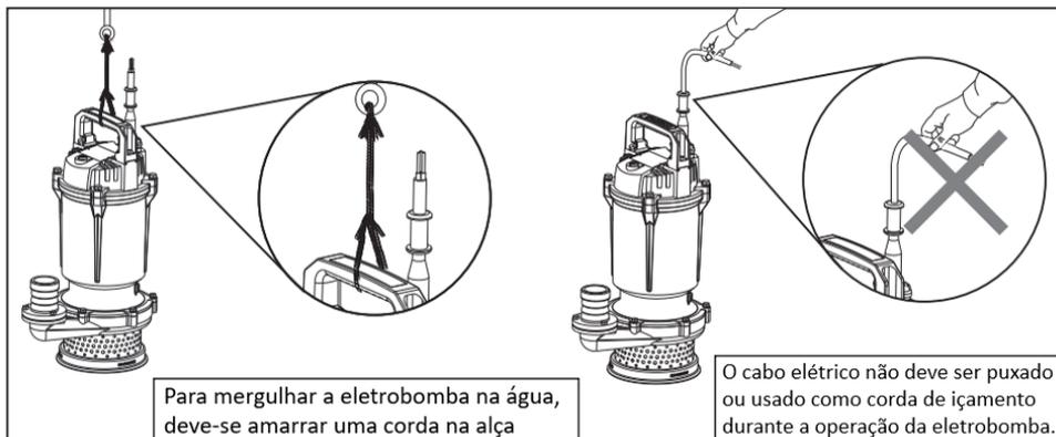
4.6 - Quando a bomba estiver imersa, sua profundidade não deve exceder 5m e deve manter uma distância mínima de 0,5m do fundo do poço. O equipamento não deve ser imerso na lama e deve-se prevenir que o impulsor não seja bloqueado ou emperrado. O nível de água deve ser verificado frequentemente para que a bomba nunca trabalhe a seco ou fora da superfície.
