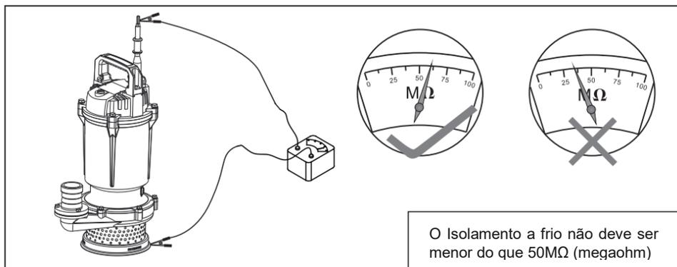
4.3 - Quanto à fiação, a bomba deve ser instalada com proteção elétrica adequada e fiação terra de acordo com as normas vigentes.
