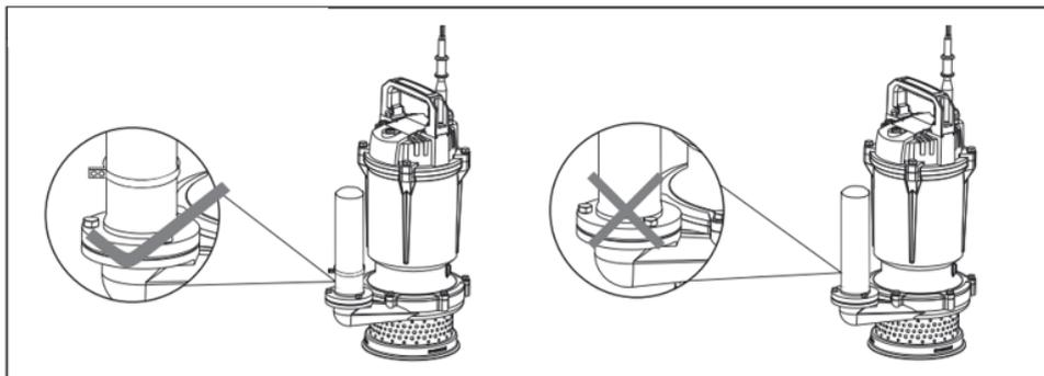
4.5 - Fica estritamente proibido puxar, enrolar ou utilizar o cabo elétrico como cabo de içamento. Durante a operação da bomba o cabo elétrico não deve ser puxado para evitar choques elétricos.
